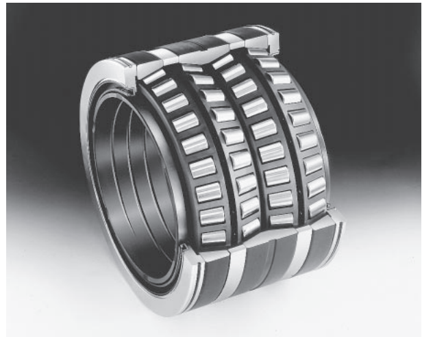
■ Rolamentos de rolos cônicos de quatro carreiras, tipo selado para pescoços de cilindro de laminação (CAT. NO. 195E)
